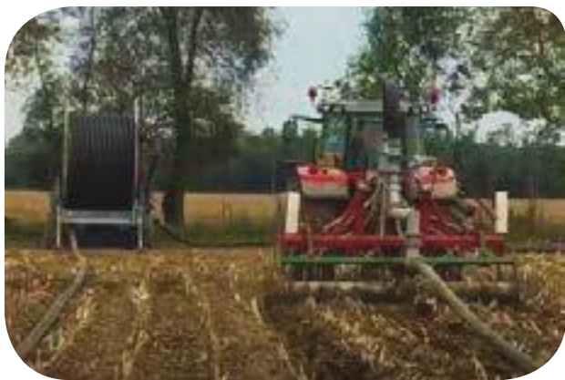
Figura 2. Interramento del digestato con ombelicale combinato alla lavorazione del terreno Picture 2. Digestate injection with umbilical system combined with soil tillage
