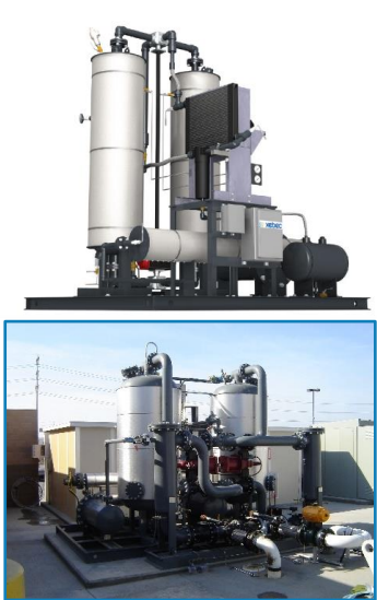
Stazioni NGX e essiccazione di gas di raffineria
