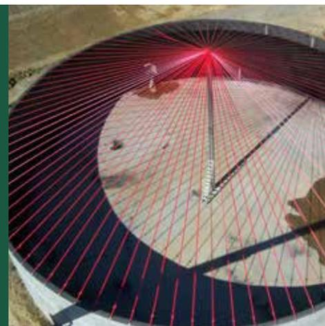
**Alfa Teloni** usa solamente saldature da **60 mm** ad **alta frequenza**, tecnica che non altera le caratteristiche fisiche del PVC.
