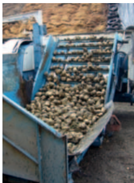
Foto 8: Realizzazione di un silobag con radici di bietola. Macchina Rotopress
