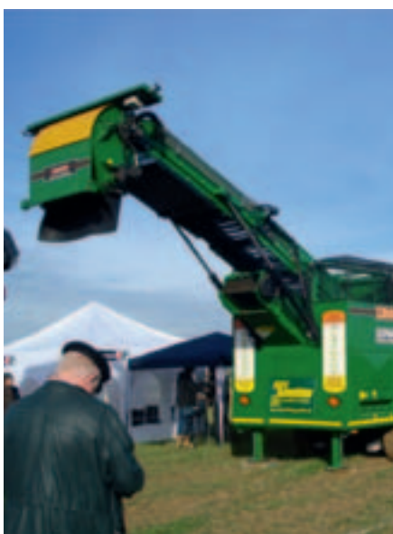
Foto 6: Lava bietole ad acqua con sistema di sterratura, spietatura e sminuzzamento delle radici. Ha grandi dimensioni e alta capacità di lavoro (fino a 100 t/ora)
