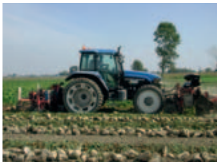
Foto 1: Cantiere separato per la raccolta delle bietole. Posteriormente il cantiere di estirpo delle radici e anteriormente il defogliatore. Questo sistema necessita di un carro raccogliatore
