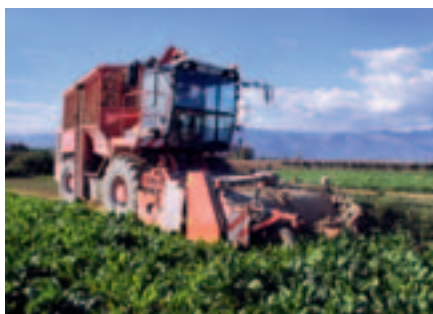
Foto 3: Cantiere riunito. Una sola macchina defoglia, estirpa e carica le radici
