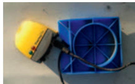
Foto 13: Valvola di sfiato. Il dispositivo giallo è un data logger usato per registrare le temperature interne al silobag.
