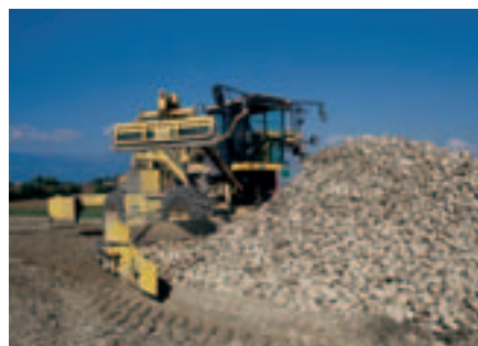
Foto 4: Sterratore caricatore bietole "mangia mucchi". Macchina utilizzata dalla filiera bieticolo-saccarifera per pulire le bietole.
