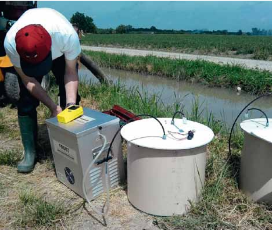
Figura 3 - Camere di evaporazione per prelievo dell'aria nei 60 minuti successivi alla fertirrigazione
