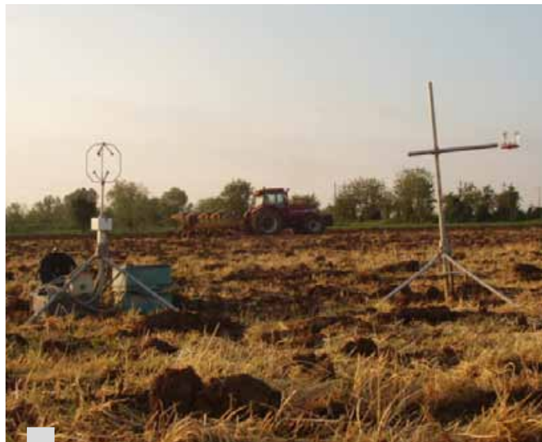
Figura 2: Sperimentazione di campo, sono visibili l'anemometro sonico e il supporto per i captatori passivi ALPHA
