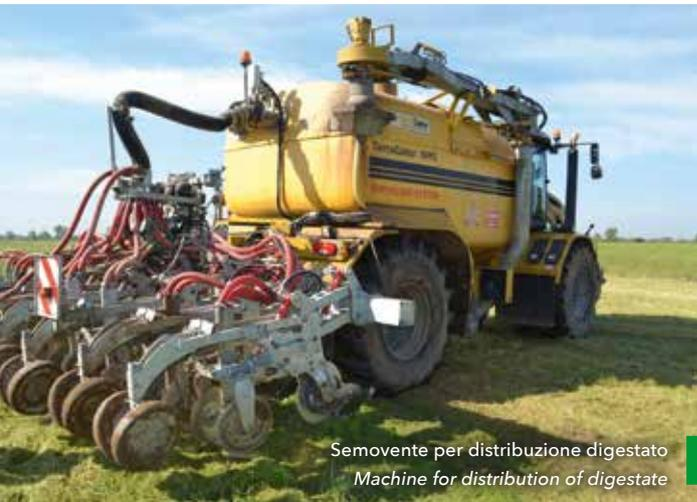
Semovente per distribuzione digestato
