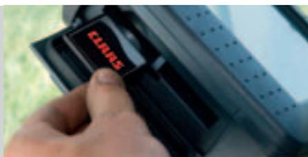
I dati della raccolta rilevati dalla CLAAS JAGUAR possono essere caricati sul sistema tramite una scheda Compact Flash
