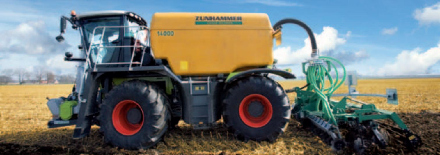
Un'alternativa all'uso di rimorchi o cisterne a sella può essere una cisterna montata (fino a 15 metri cubi) sullo XERION SADDLE TRAC o sul TRAC VC (con cabina girevole). Lo XERION si trasforma così in uno spandiletame semovente, tuttavia con il vantaggio che può essere utilizzato anche per numerosi altri lavori.
