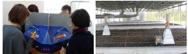
L'olfattometro TO8 (a sinistra) e cappe di prelievo odore su biofiltro
