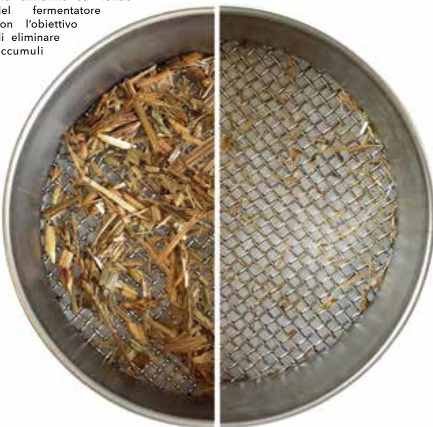
Figura 2: Caratterizzazione di biomasse e valutazione di pretrattamenti mediante analisi granulometrica. Confronto tra silotriticale non trattato (sinistra) e sottoposto a pretrattamento meccanico (destra); particolare della frazione granulometrica con  $D > 5$  mm.
