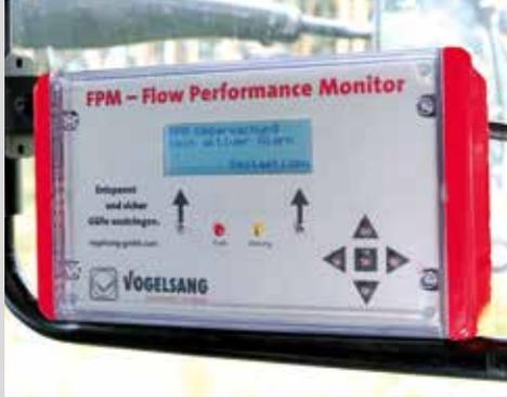
Flow Performance Monitor (FPM) monitora elettronicamente la distribuzione del fertilizzante organico. Il sensore si installa con semplicità nei tubi flessibili di XTill, rilevando eventuali interruzioni nello scorrimento e attivando, in tal caso, un segnale di allerta per l'operatore.
