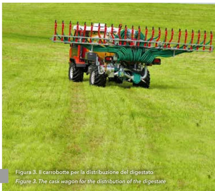
Figura 3. Il carbotte per la distribuzione del digestato
