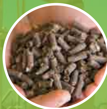
Postrattamento Pellet di digestato
