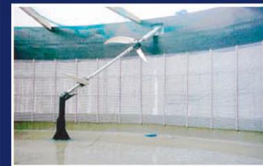
Miscelazione e riscaldamento all'interno dei digestori
