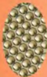
Fornite con il marchio rinomato Resinex™, la nostra gamma di prodotti per lo scambio ionico è efficace nel trattamento delle acque contaminate, contenenti metalli pesanti.
