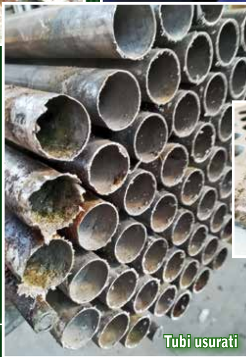
Esempio di scambiatore da riparare
