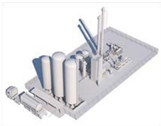
Grazie alla profonda esperienza ed alle competenze maturate nell'ambito delle tecnologie criogeniche, SIAD Macchine Impianti ha sviluppato la nuova linea di impianti SMART LNG per la produzione di gas naturale liquefatto (GNL) e biometano su piccola e media scala.
