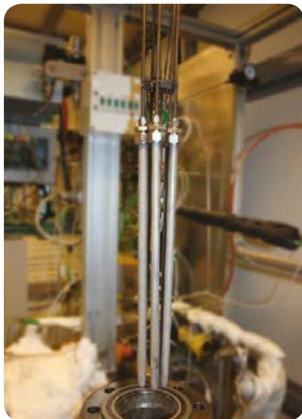
Figura 4. Il reattore a membrane in scala da laboratorio al TU/e
