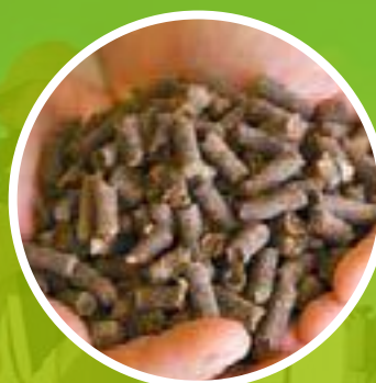
Postrattamento Pellet di digestato
