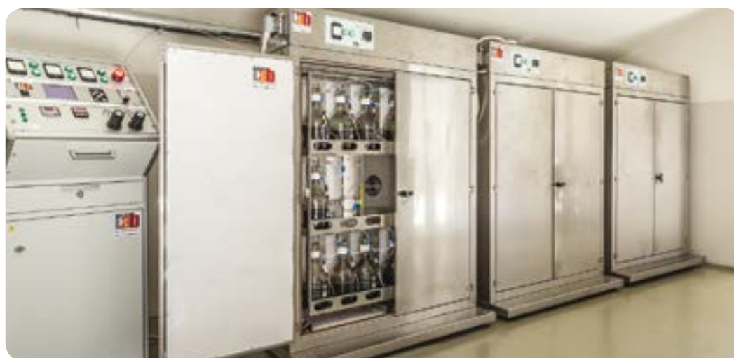
Sistema di misura del potenziale metanigeno di CRPA
