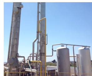
Ragusa (Italia) - Rimozione CO 2 da gas di coda impianto metano
