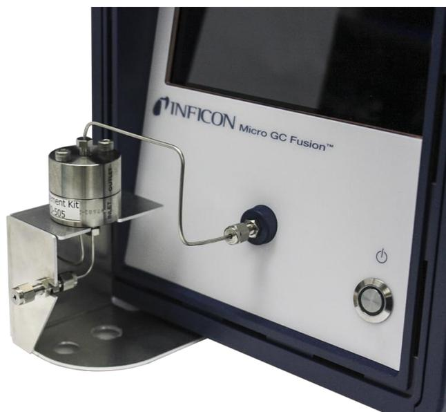
Figura 17- Uso del sistema GENIE Filter su Micro GC Fusion
