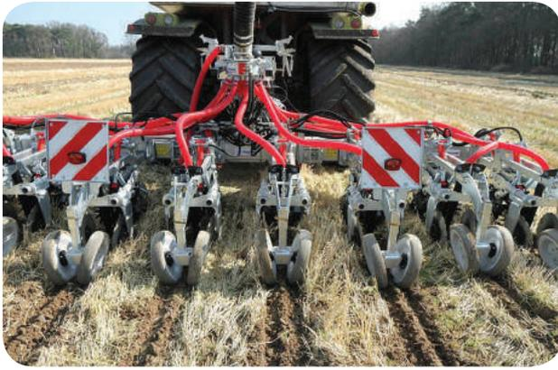
Figura 3: Particolare di una distribuzione sottosuperficiale mediante la tecnica dello strip-tillage.
