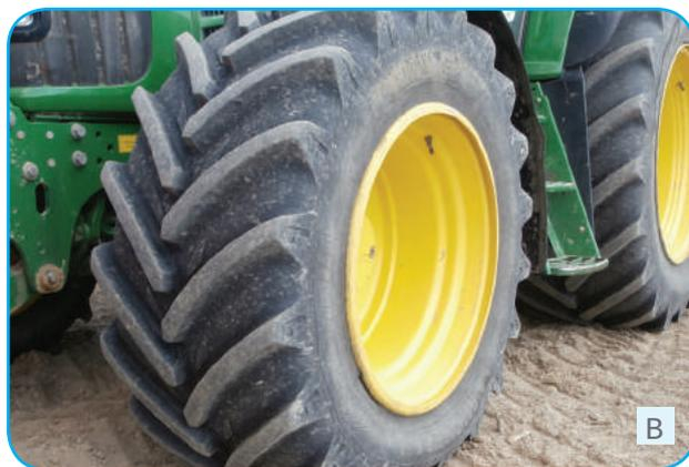
Figura 1: Per ridurre la pressione sul terreno è necessario o limitare la massa del veicolo o aumentare la superficie di contatto tra gli organi di propulsione e il suolo operando quindi con cingolature (A) o pneumatici larghi e a bassa pressione (B) in grado di migliorare la ripartizione dei carichi.
