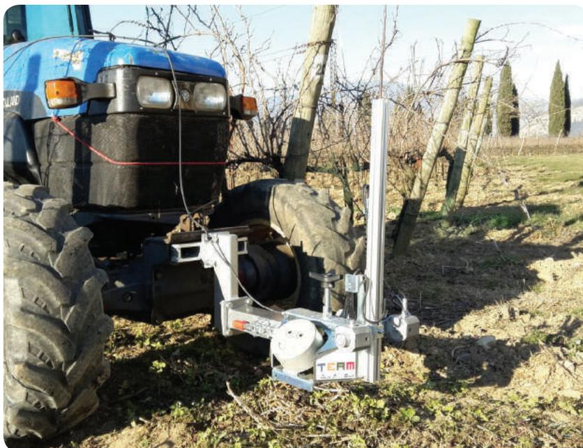
Figura 3: Sensore implementato da VITISOM per la lettura del vigore per la lettura dal legno di potatura
