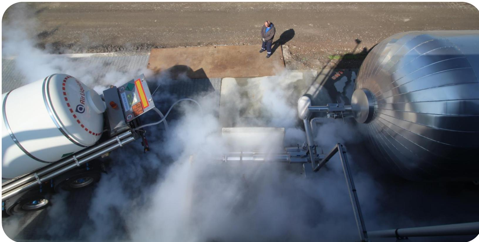
Particolare del travaso di CO<sub>2</sub> da serbatoio ad autocisterna - Impianto PENTAIR modello «Evoluto-*plus*»
