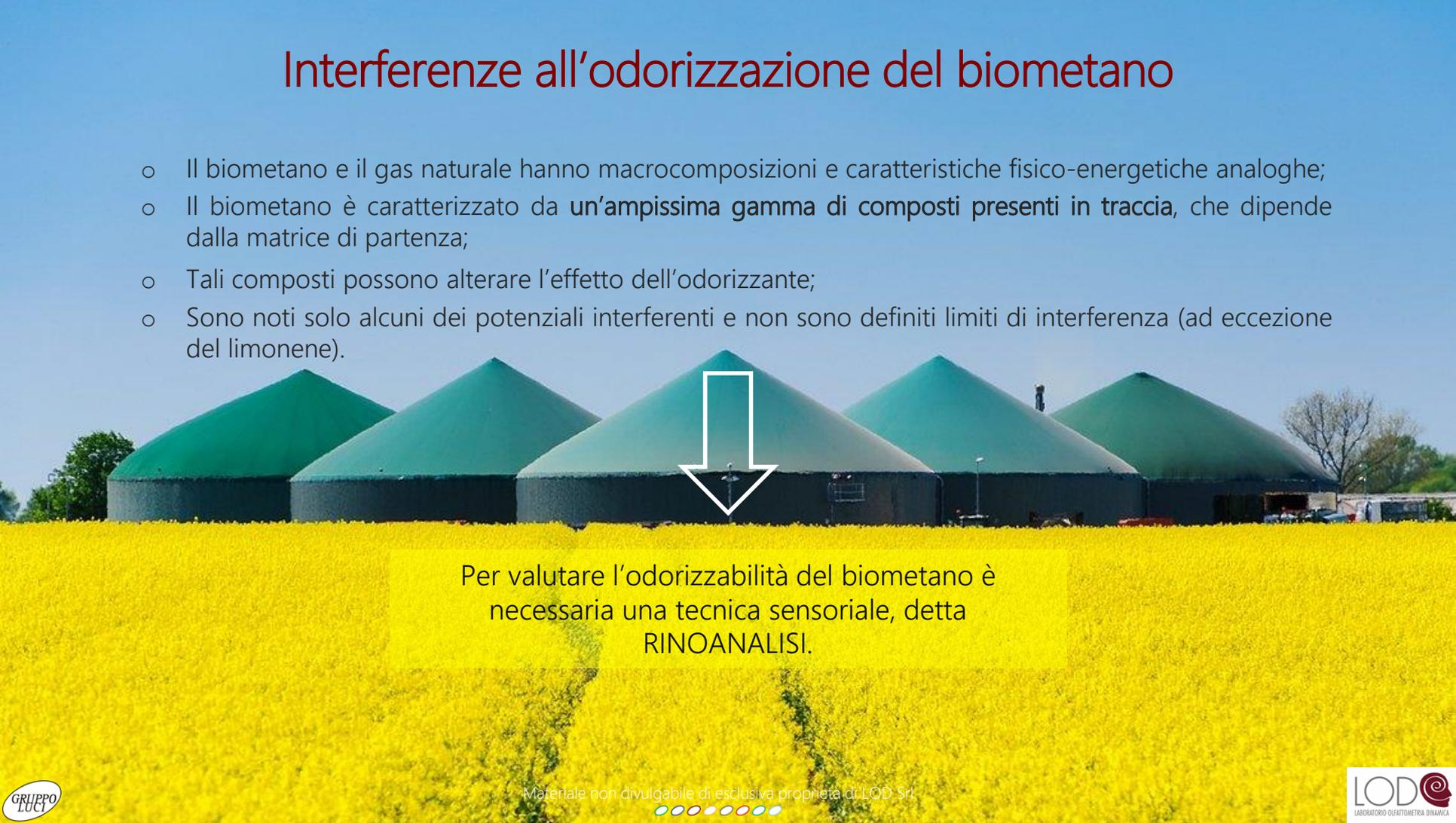
Per valutare l'odorizzabilità del biometano è necessaria una tecnica sensoriale, detta **RINOANALISI**.
