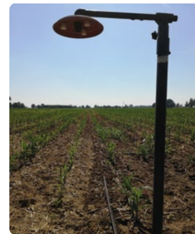
Figura 6: Le emissioni di ammoniaca sono state misurate con campionatori passivi posizionati su paline Figure 6: Ammonia emissions has been measured with passive samplers installed on must in the fields
