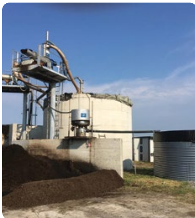
Figura 4: Impianto filtrazione del digestato utilizzato per la fertirrigazione con pivot Figure 4: Digestate filtration plant used for pivot fertigation
