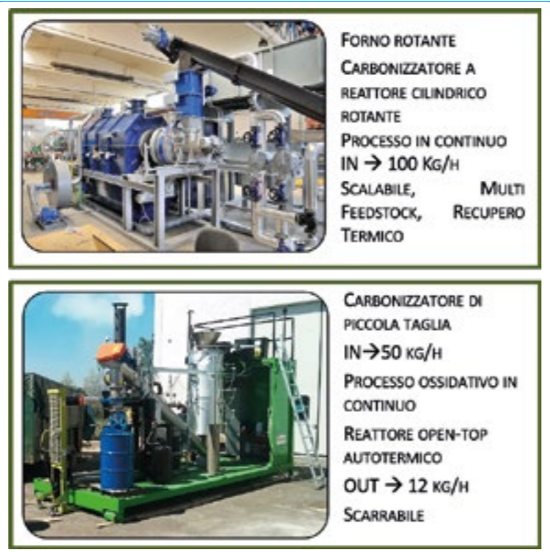
Figura 2: Alcuni degli impianti di pirolisi presso il consorzio RE-CORD Figure 2: Some of the pyrolysis pilot unit available at RE-CORD workshop
