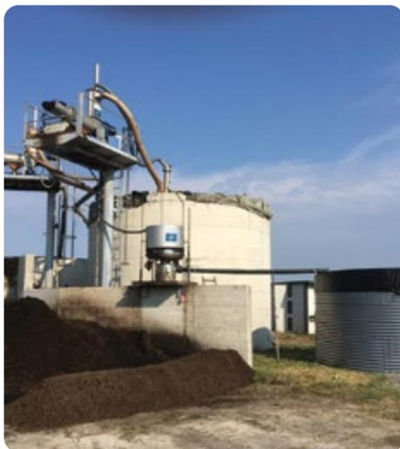
Figura 4: Impianto filtrazione del digestato utilizzato per la fertirrigazione con pivot
