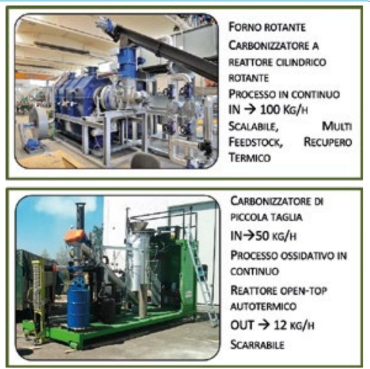
Figura 2: Alcuni degli impianti di pirolisi presso il consorzio RE-CORD
