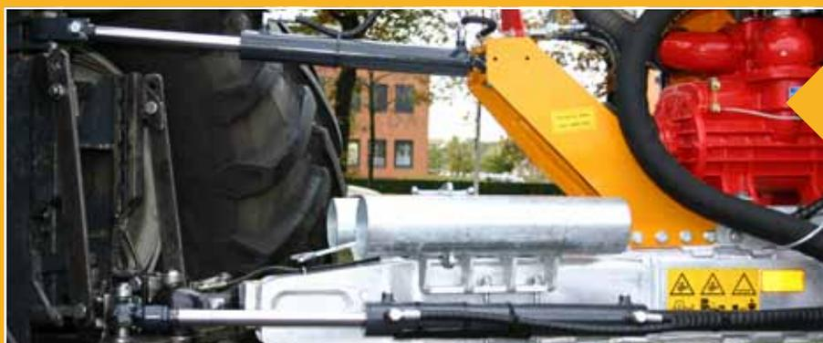
Il trattore ha un'ottima forza di trazione grazie al timone sospeso ed al cilindro a terzo punto che garantisce la stabilità della macchina e non limita le manovre.
