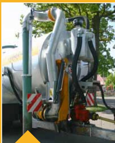
Vi sono varie tipologie di bracci pescanti, sia con sistemi per il pescaggio da vasche, sia con docking system, con o senza acceleratore di carico.
