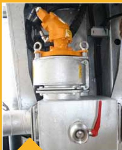
Grazie alla disposizione dell'acceleratore di carico sotto la cisterna, esso può essere utilizzato sia per la saracinesca di destra, sia per quella di sinistra ed ovviamente anche per il braccio pescante, per assicurare il contenimento dei tempi di attesa.
