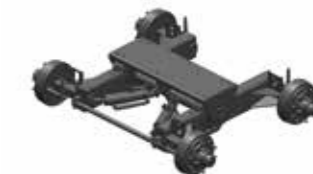
18 ton assale tandem a bilancere autosterzante
