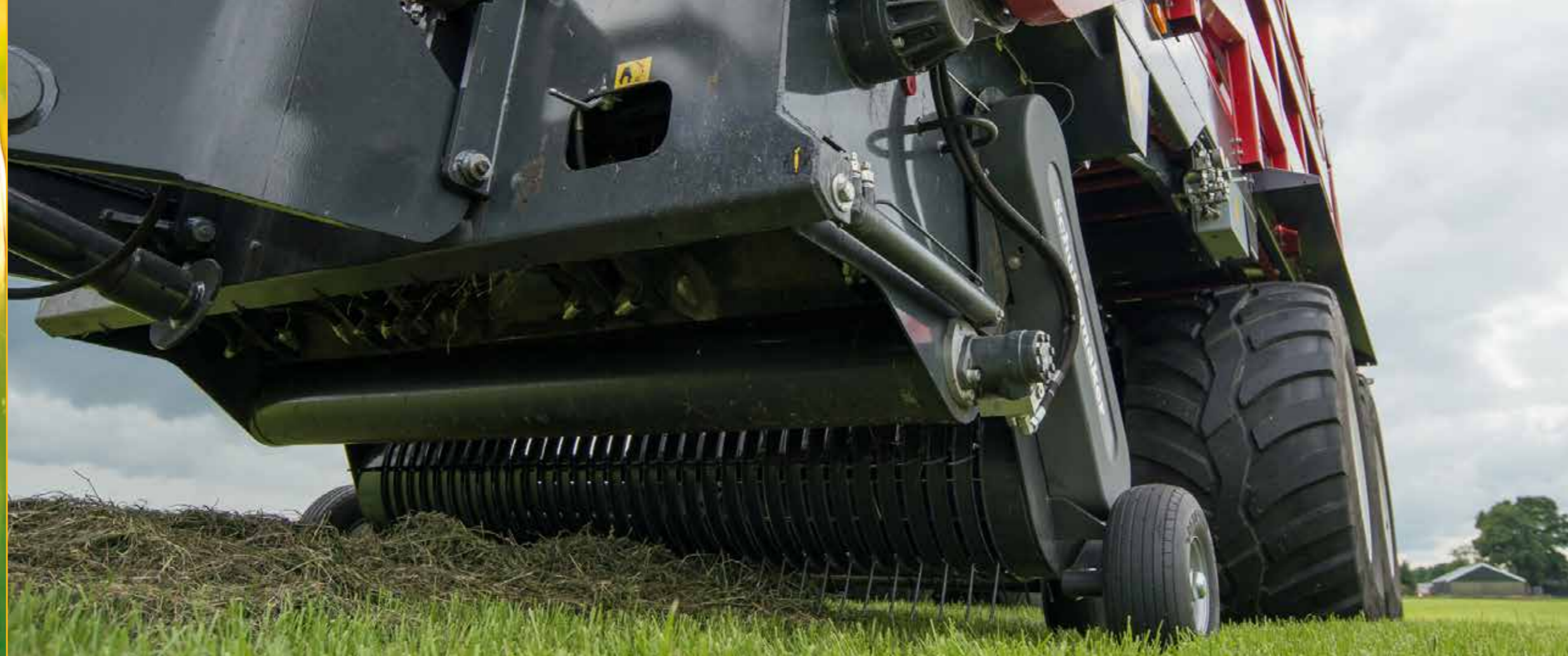
18 ton assale tandem a bilancere non sterzante
