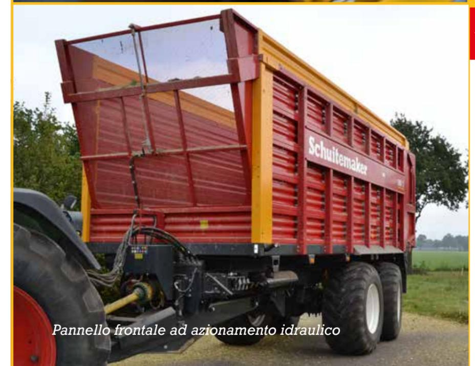
Pannello frontale ad azionamento idraulico
