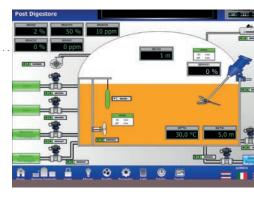
SEBIGAS ha proposto un impianto biogas costituito da una prevasca di carico e da due digestori. L'impianto funziona con i soli sottoprodotti dell'azienda, ovvero liquame e letame bovino e 1% di scarti da essiccazione del mais.
