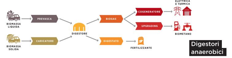
SEBIGAS propone impianti biogas CSTR (Continuous-flow Stirred Tank Reactor), tecnologia basata su un flusso semi-continuo di biomassa fresca che entra in reattori miscelati a temperatura controllata ed esce come biogas e digestato.
