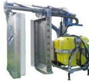
Irroratrici a convogliamento d'aria o a recupero con precisa gestione del flusso verso il bersaglio con **portata d'aria, di miscela e direzione regolate in modo continuo** ed automatico in base alle rilevazioni fatte da **sensori ad ultrasuoni** rispetto al vigore vegetativo.
