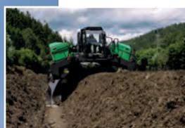
Il materiale è stabilizzato con rivoltamento tradizionale con la rivolta cumuli Komptech Topturn o pala gommata Cat®. Una volta maturo, viene lavorato con vagli
