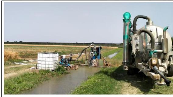
Impianto di fertirrigazione: utilizzo del digestato diluito con acqua
