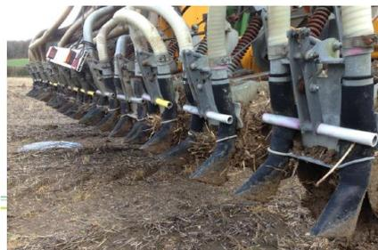
Spandimento in bande con trailing shoe (inizione poco profonda)
