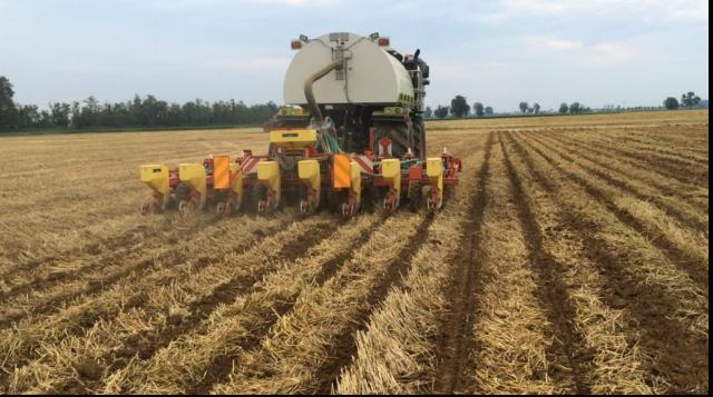
Il digestato viene completamente interrato e localizzato nella striscia di semina lavorando direttamente sulle stoppie della coltura vernina appena raccolta.
