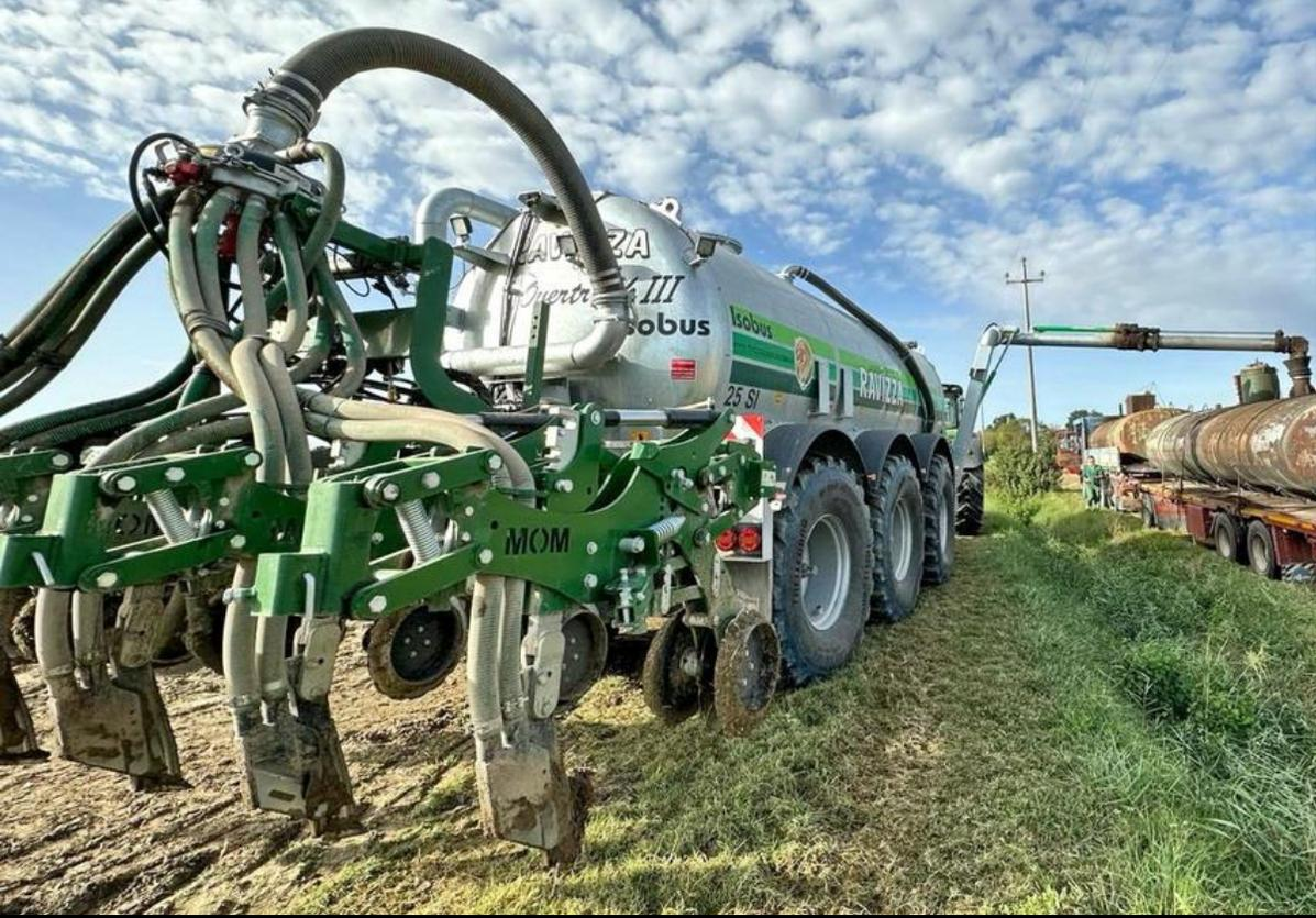
**Interramento del digestato liquido con strip-till ovvero lavorazione della sola striscia da seminare e localizzazione del fertilizzante organico**
