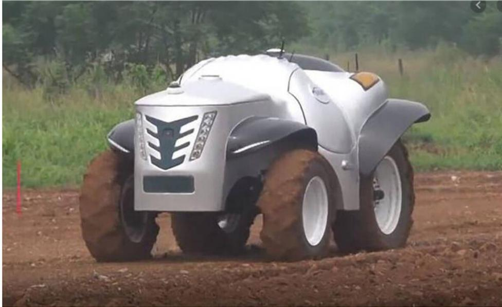
**ET504-H: trattore a guida autonoma a idrogeno.**
