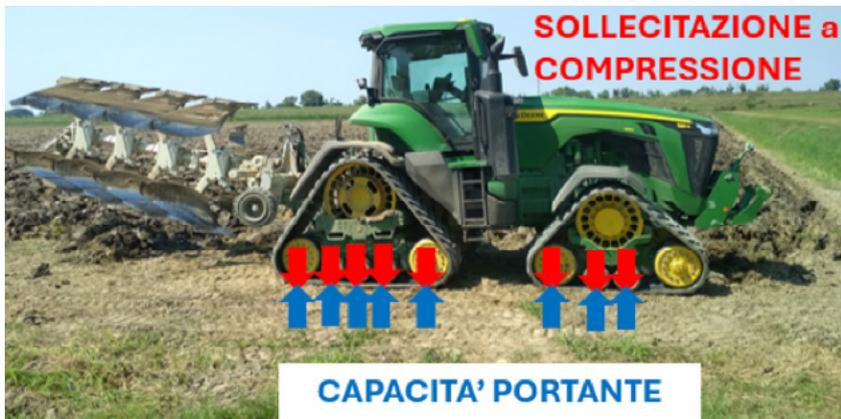
Figura 1: Il rischio di compattamento è determinato dall'interazione tra capacità portante e sollecitazione del terreno dovuta al traffico delle macchine agricole.
