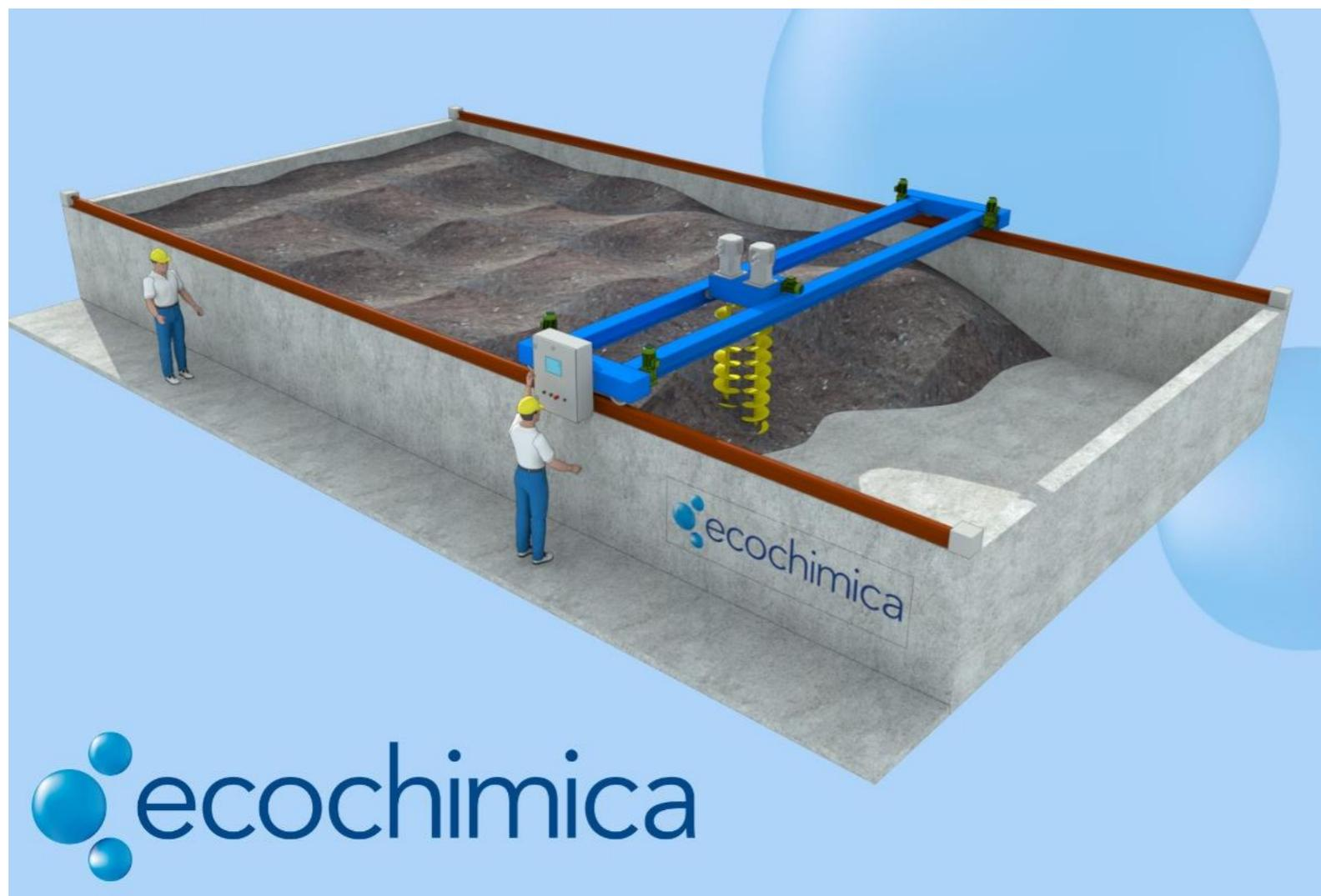
**Il sistema su rotaie con rivoltatori solleva lo strato inferiore di materiale organico digerito areandolo ed omogeneizzandolo. Ciò consente di avere una giusta fermentazione aerobica e velocizzare il processo di maturazione del compost**
