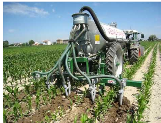
Utilizzo in copertura ed interramento
